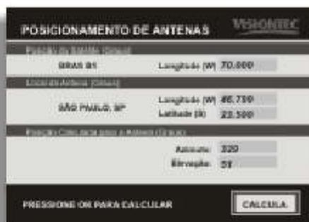
O receptor VT 3200 fornece ao usuário o posicionamento da antena a ser instalada. Para este cálculo é necessário escolher o Satélite desejado e o Local (cidade) onde o sistema será instalado.
